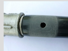
Reparaturstelle reinigen und aufrauen
